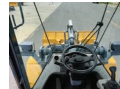
Coluna de direção com ajuste de altura e rebatimento. Assento ajustável com amortecimento bidirecional, apoio de braço e para-sol inclusos.
