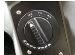
Seletor de faixas de trabalho com 3 modos de operação (econômico, normal e força total). Com economia de até 15% de combustível.
