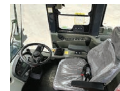
Coluna de direção com ajuste de altura e rebatimento. Assento ajustável com amortecimento bidirecional, apoio de braço e para-sol inclusos.
